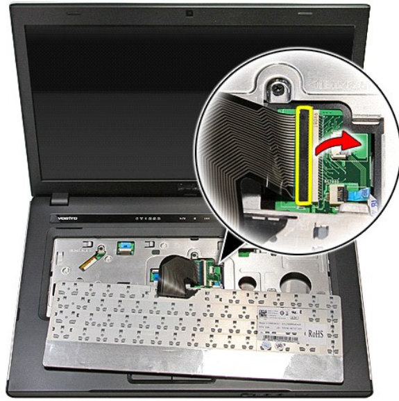
7. احصل كل لوحة المفاتيح من الموصل الخاص به الموجود في لوحة النظام، وقم بإزالة لوحة المفاتيح من الكمبيوتر.
