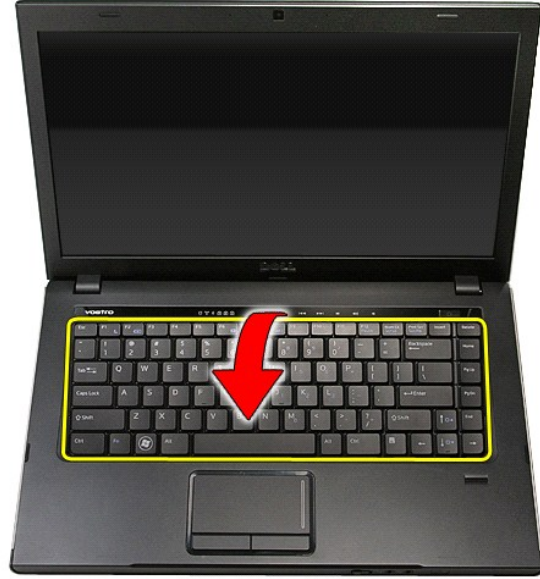
6. افتح المشبك بحرص لتحرير كل لوحة المفاتيح.
