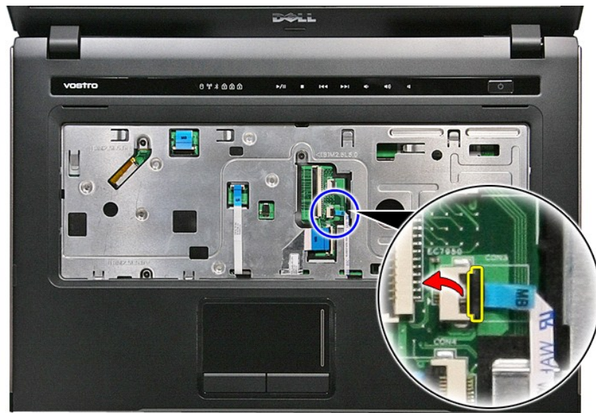
71. احصل كبل قرأى بصمات الأصابع من الموصل الخاص به الموجود في لوحة النظام.
